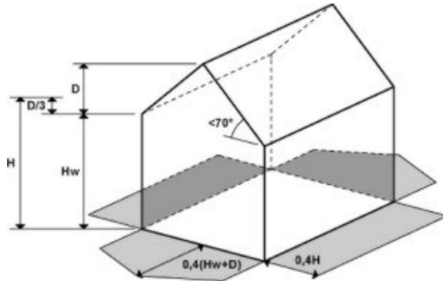
Abstandsflächen bei Dachneigungen  $\geq 70^\circ$ :
