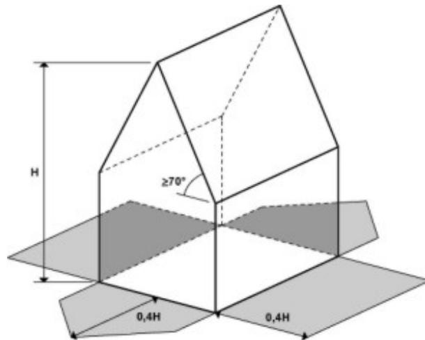
Die Berücksichtigung der Dachneigung bei der Ermittlung der traufseitigen Wandhöhe im Fall eines Tonnendaches entsprechend § 6 Abs. 4 Satz 4 erfolgt nach der Formel
